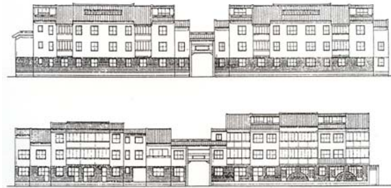
Gambar 15. Tampak bangunan Beijing Ju'er Hutong. Struktur bangunan ditambah, dari 1 lantai menjadi 2 lantai (Beng, 1998)
